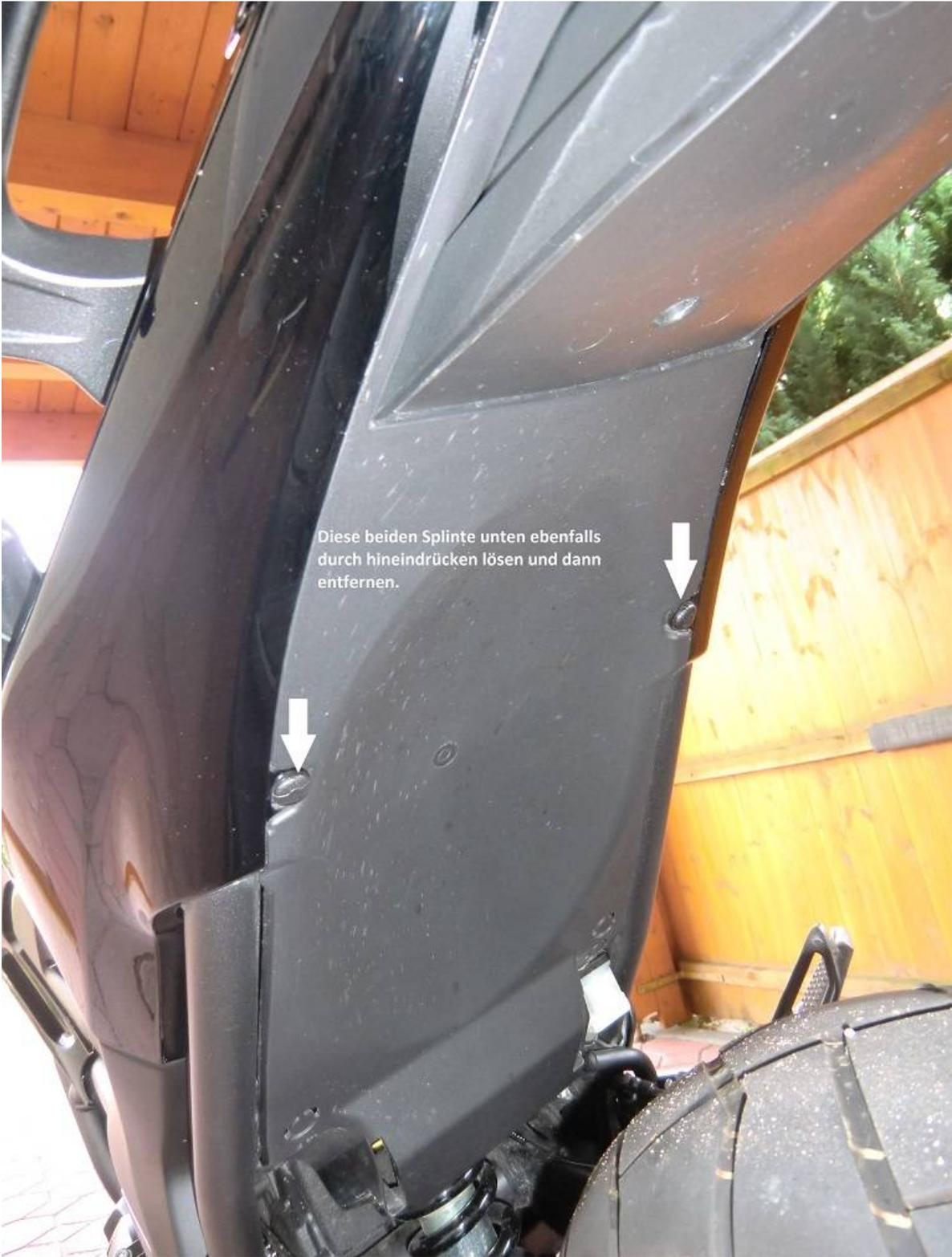
Diese beiden Splinte unten ebenfalls durch hineindrücken lösen und dann entfernen.
