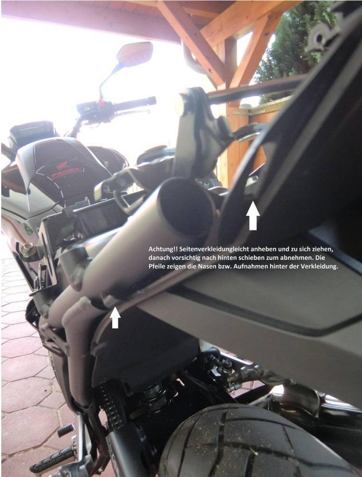
Achtung!! Seitenverkleidung leicht anheben und zu sich ziehen, danach vorsichtig nach hinten schieben zum abnehmen. Die Pfeile zeigen die Nasen bzw. Aufnahmen hinter der Verkleidung.
