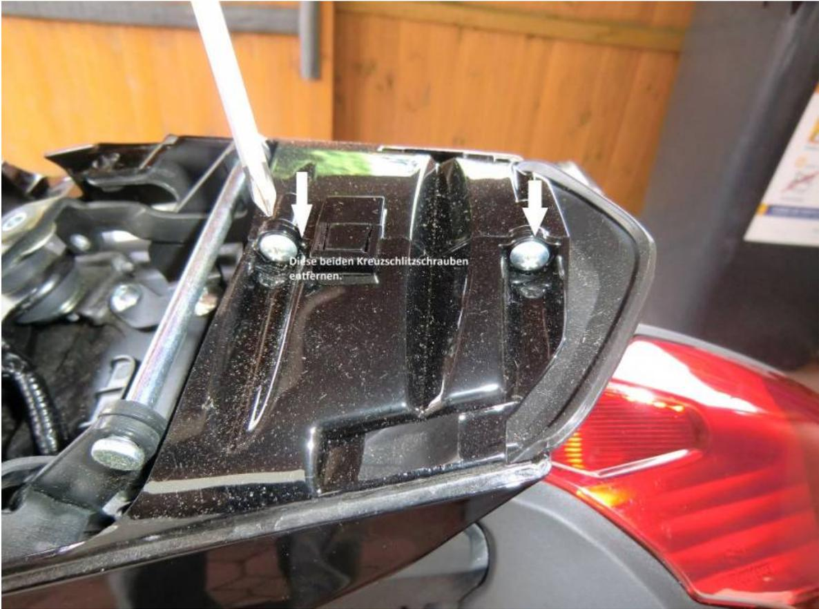
Diese beiden Kreuzschlitzschrauben entfernen.
