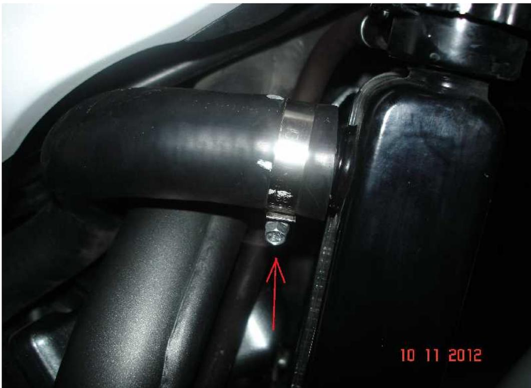
Die 3 Schrauben vom Zylinderkopfdeckel und die Schelle vom Entlüftungsschlauch lösen, Schlauch abziehen, anschließend den Ventildeckel abnehmen
