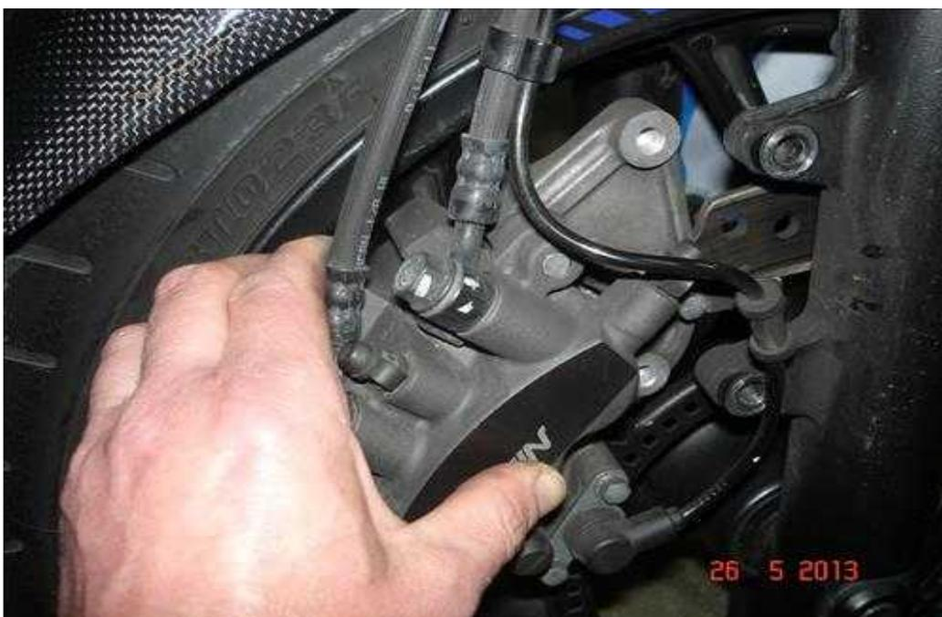
**Für den Wechsel der Bremsbeläge müssen die Kolben noch weiter eingedrückt werden. Das funktioniert (wenn die Kolben in Ordnung sind) am besten mit einem Kreuzschlitzdreher mit breiter Klinge.**
