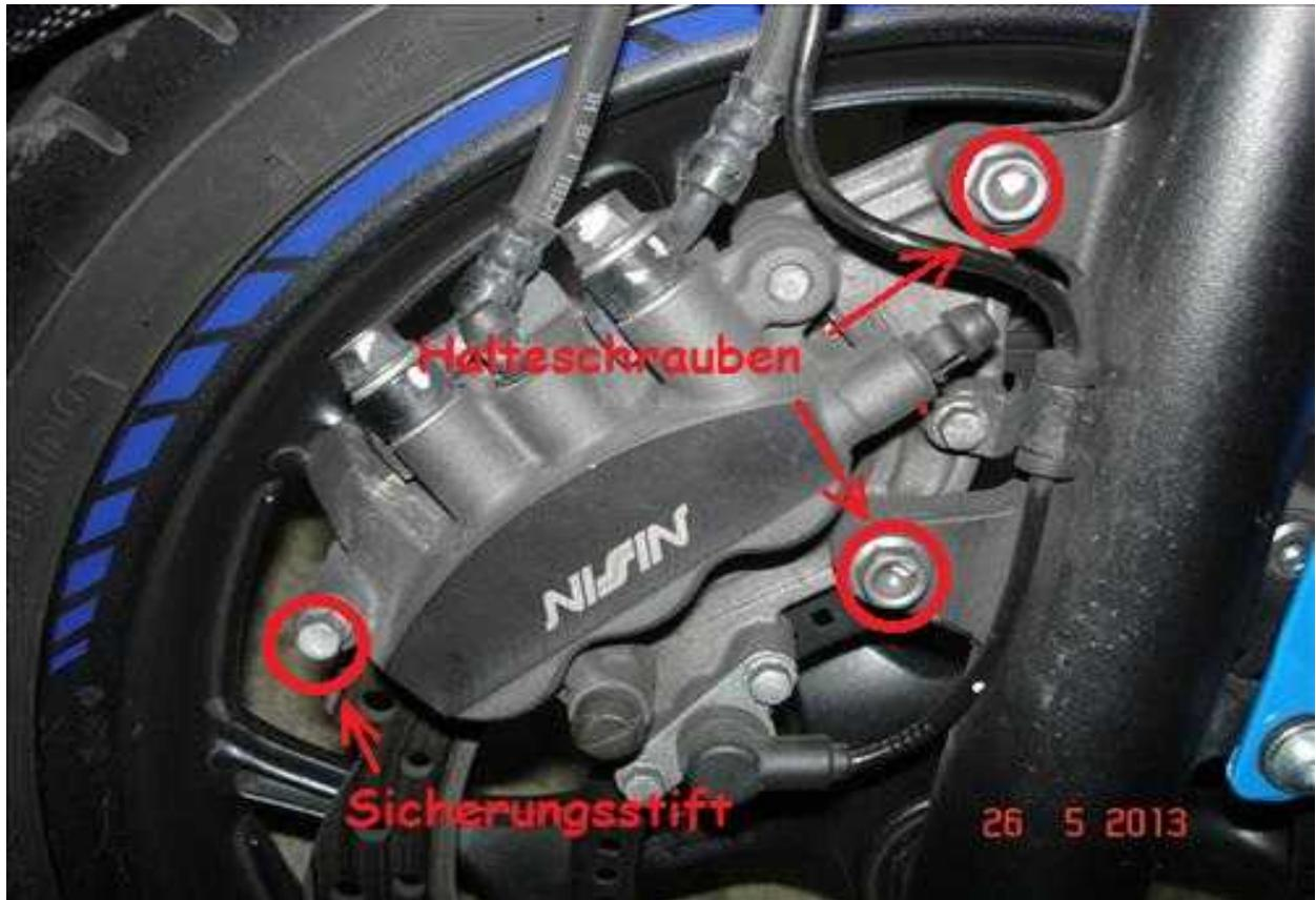
Der Bremssattel wird in Richtung Achse gekippt, damit werden die Bremskolben zurück gedrückt. Anschließend kann man den Sattel abnehmen.
