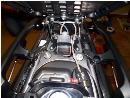
Tank, Leitung zur Pumpe mit Rückschlagventil und Pumpe von der Seite gesehen und von oben mit bereits gefülltem Öltank (gefüllt wird aber erst am Schluss)
