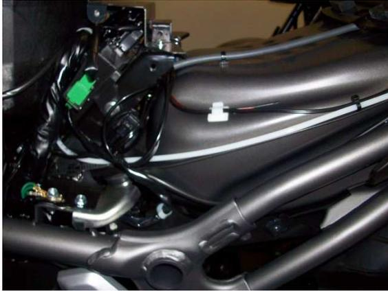
Auf diesem Bild sieht man die Verlegung der Ölleitung Richtung Pumpe im Heck. Darüber sieht man die Elektroleitung, die von der Steuerung zur Pumpe geht.
