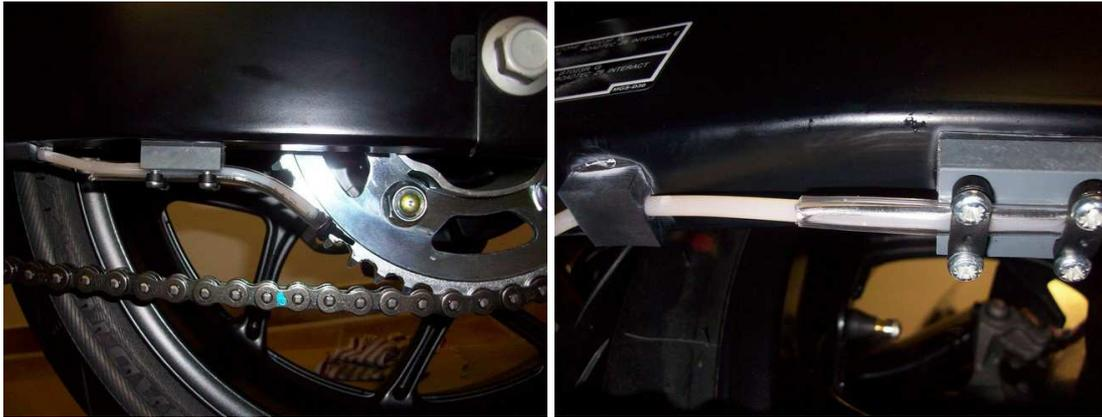
Düse mit Montageklotz und Montageklotz von unten gesehen.
