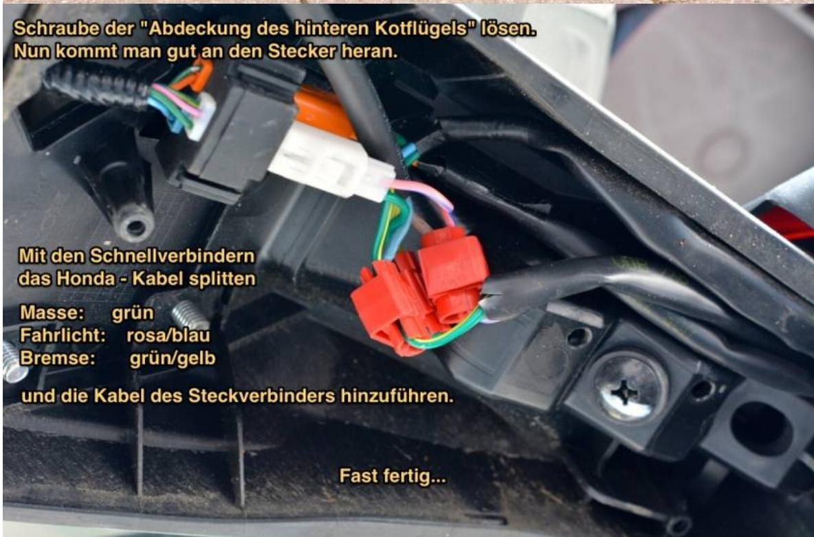
**Schraube der "Abdeckung des hinteren Kotflügels" lösen.
