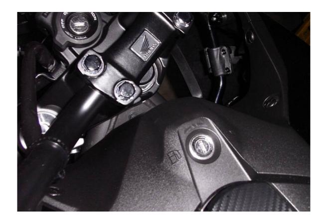
Nun noch das Kabel bis zur Batterie gezogen und über eine 10A Sicherung an die selbige angeschlossen.
