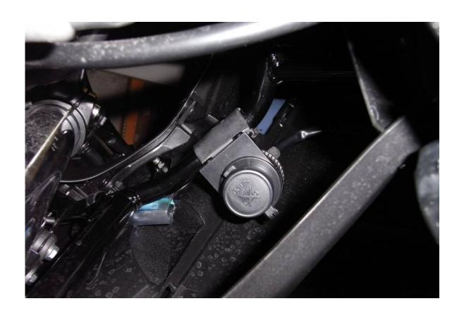
Ach so – natürlich habe ich die Kabeleinführung an der Buchse selbst, vor Einbau mit selbstvulkanisierendem Band abgedichtet und auch das Kabel zugentlastet.
