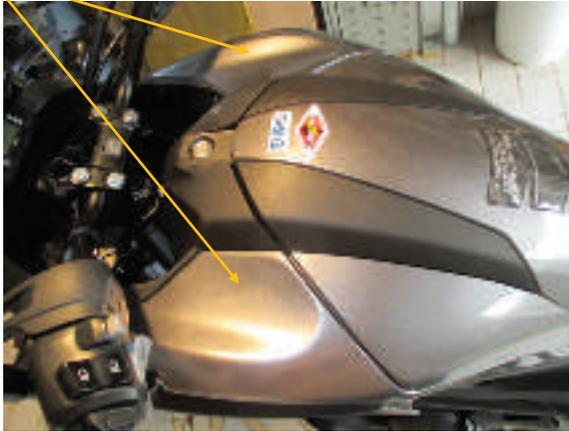
Kunststoffclip - links und rechts je 2 entfernen (Kunststoffclipe in der mitte reindrücken) - Ansicht rechts
