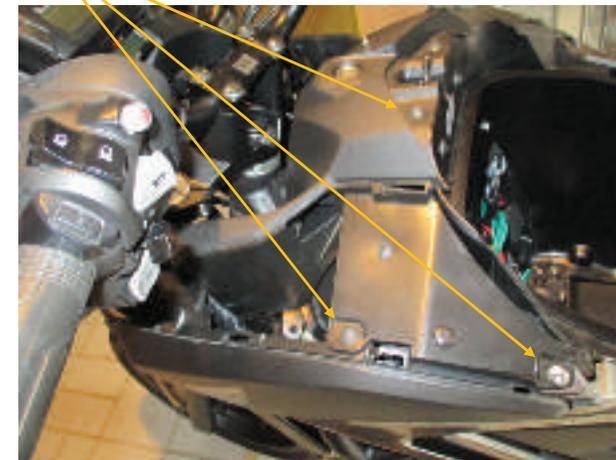
Innensechskantschrauben - rechts entfernen - Ansicht rechts
