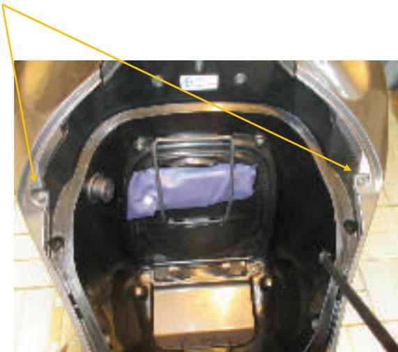
Innensechskantschrauben - links entfernen – Ansicht links
