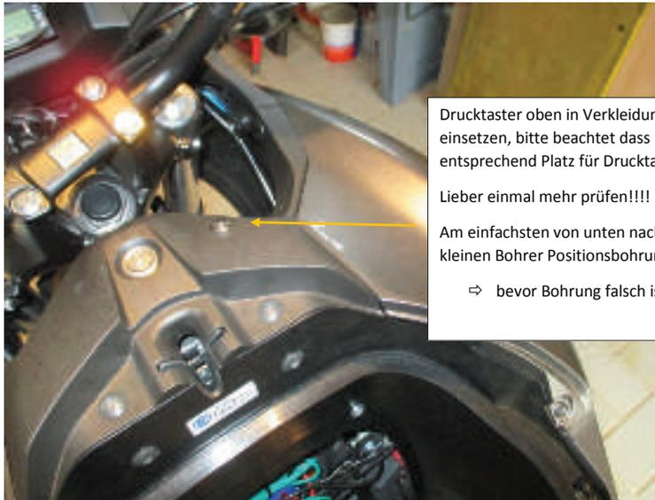
Drucktaster oben in Verkleidung bohren und einsetzen, bitte beachtet dass unten entsprechend Platz für Drucktaster ist.
