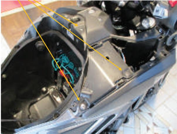
Kunststoffverkleidung nach Oben entfernen und in Staufach legen – Ansicht von Lenker
