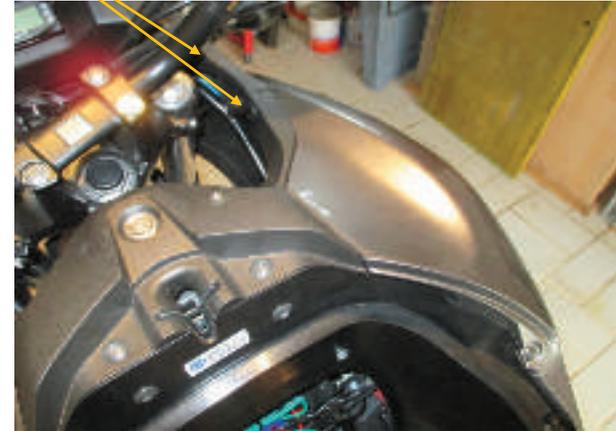
Kreuzschlitzschraube entfernen - Ansicht Staufach
