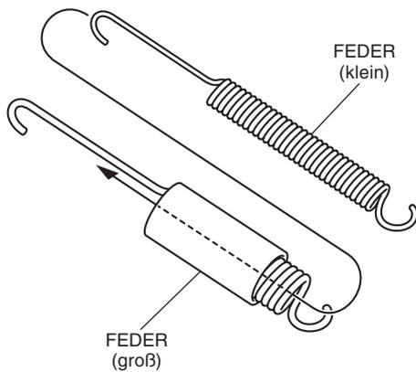
8. Die zusammengebauten Federn installieren, wie in der Abbildung gezeigt.
