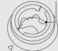
Füllen Sie nie mehr Kraftstoff als bis zur Unterkante des Einfüllstutzens ein.
