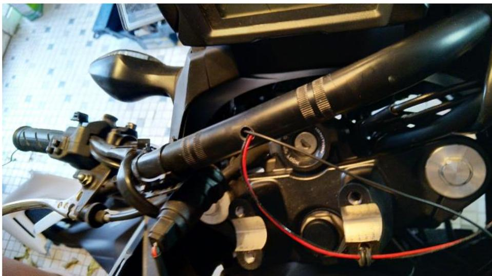
Sind beide Kabel durch muss der Gummistopfen drauf und ins Loch gedrückt werden. Das ist wieder etwas fummelig sollte aber keine größere Herausforderung darstellen.
