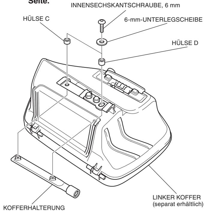
8. Montieren Sie den linken Koffer, und ziehen Sie alle losen Befestigungselemente gemäß Drehmomenttabelle an.
