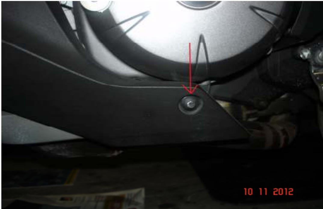
Die Halterung ist weiterhin mit zwei seitlichen und zwei vorderen Stopfen befestigt. Nach Lösen der beiden Schrauben kann sie leicht aus den Gummitüllen ziehen.
