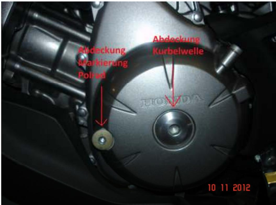
Kurbelwelle entgegen dem Uhrzeigersinn drehen, bis die Markierung für den oberen Totpunkt sichtbar ist. Anschließend überprüfen, ob Einlaß- und Auslaßventile Spiel haben. Falls nicht, die Kurbelwelle um 360° weiter drehen.
