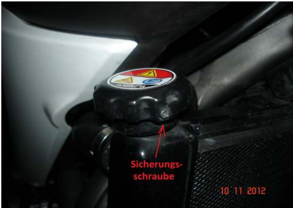
Hier befindet sich die Schraube vorn, aber der Deckel lässt sich auch um 180° verdreht aufschrauben – es kann also sein, dass man die Schraube nicht sieht!
