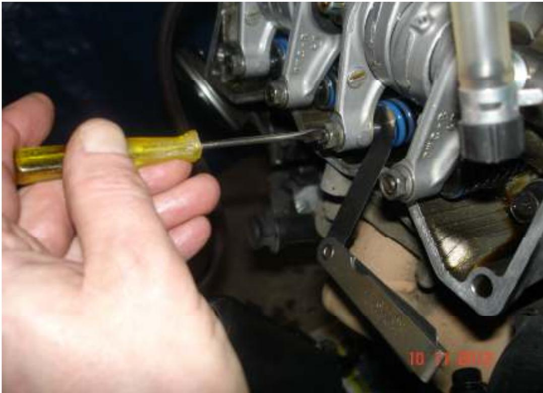
Ich schiebe die Lehre mit dem korrekten Wert unter die Schraube und drehe sie fest, bis sich die Lehre so gerade noch durchziehen läßt. Anschließend die Kontermutter festschrauben und überprüfen, ob sich das Spiel verstellt hat. Falls ja, Kontermutter lösen, Einstellschraube ein paar Grad zurückdrehen und Kontermutter wieder festschrauben. Wieder überprüfen... usw. - bis es passt!
