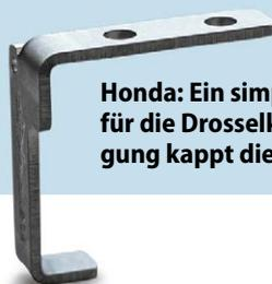
**Honda: Ein simpler Anschlag für die Drosselklappenbetätigung kappt die Leistung**
