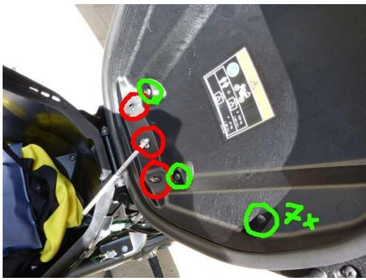
Zur vollständigen Demontage des Gepäckboxdeckels in seine Einzelteile muss man weitere zwei Innensechskant-Schrauben (rot) lösen.
