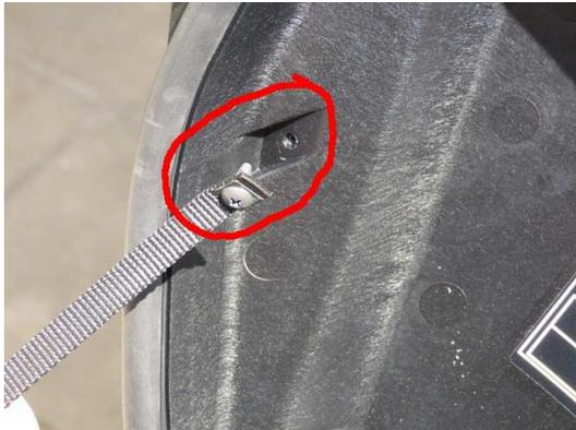
Wenn man nun die drei Innensechskant-Schrauben (rot) löst, kann man den Gepäckboxdeckel mit etwas Gefrickel entfernen. Leichter geht es jedoch, wenn man die restlichen Kreuzschlitz-Schrauben (grün) ebenfalls löst.
